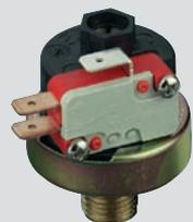
**Einsatz:** Druckschalter werden in Leitungssystemen mit flüssigen oder gasförmigen Medien eingesetzt. Beim Erreichen eines eingestellten Druckes gibt der Schalter ein elektrisches Signal zur Weiterverarbeitung frei.
